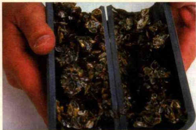
(a) 被斑纹贻贝严重阻塞的进水管断面。(© Peter Yates / Getty Images)
