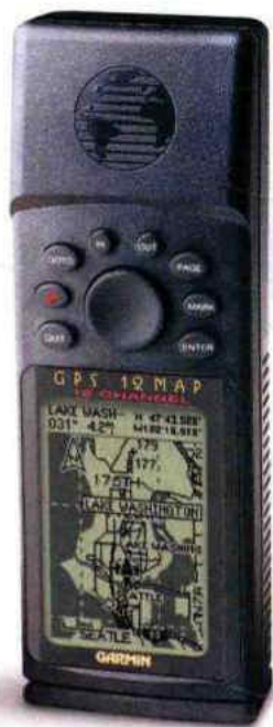
图2.4 这种手持GPS接收器在一个小型液晶显示屏上显示经纬度和一张地图。（Courtesy Garmin Corporation）
