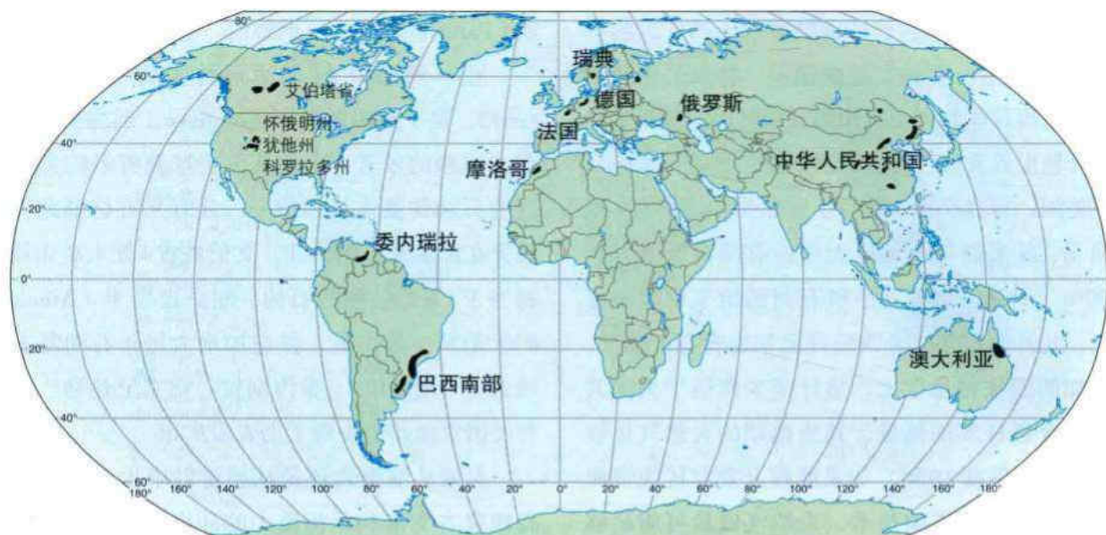
图5.13 油页岩矿床。美国最丰富的油页岩矿床蕴藏于绿河组，拥有世界已知油页岩储量的大约2/3。在找到经济地进行加工、解决废弃物处理和采矿点土地修复的方法之前，油页岩不大可能成为主要的资源。
