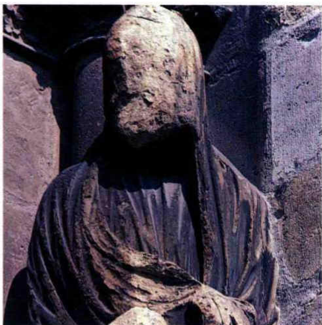
图12.13 法国兰斯市（Reims）教堂这座石灰岩雕塑见证了酸雨的破坏作用。硫酸把石灰岩转化为石膏，并在多年同雨水接触中被冲刷掉。（© William E. Ferguson）
