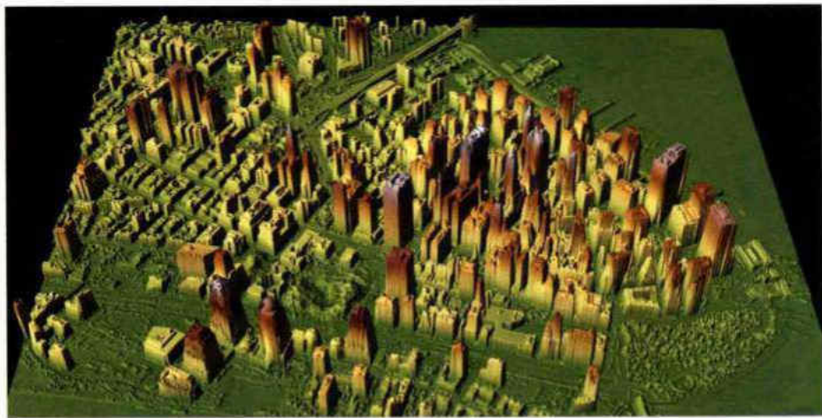
图2.26 世贸中心现场的三维激光雷达影像。“9·11”袭击后利用遥感、GPS和GIS集成的世贸中心残骸精确地图在恢复与清理工作中的价值是无法估量的。全球定位系统被用以部署地面和空中传感器。装备了3种传感器的航空器收集高分辨率的航空照片、热影像和激光雷达（光探测与测距）数据。资料收集后的几小时内，来自政府、工业界和学术界的GIS专业人员把数据进行合并，编制出大楼与周围地区的高分辨率大幅影像。根据激光雷达系统编绘的三维模型使工程技术人员能够计算瓦砾堆的体积，跟踪其运动与变化，并确定起重机将其清除所需的范围。
